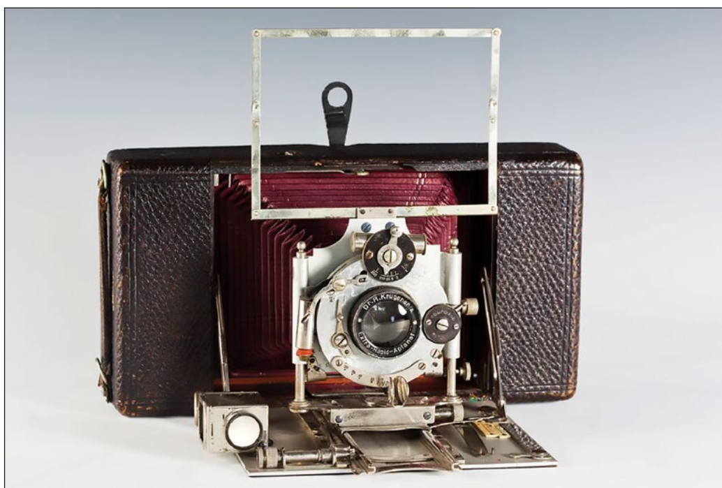
Figura 2 - Krügener Delta Cartridge Camera con mirino a traguardo
